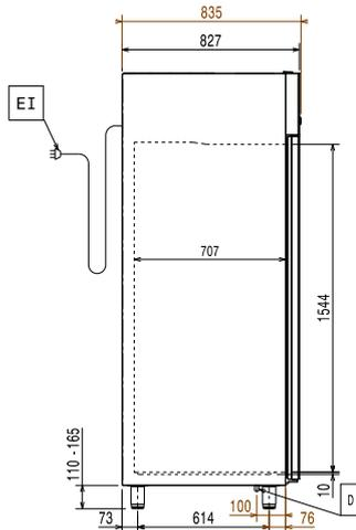
ED = Raccordement électrique à distance
